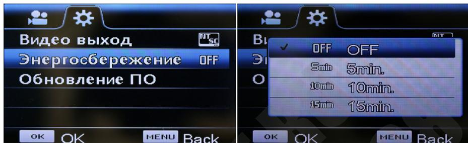
**Обновление программного обеспечения:** пользователь может запросить у производителя файл с последней версией программного обеспечения и произвести обновление самостоятельно.
